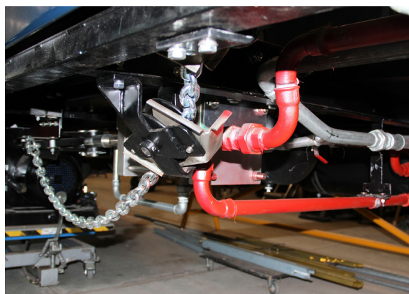
Zakraammechaniek heeft een bijzondere constructie. De eerste ramen zijn aangebracht. Het luchtremstelsysteem onder de tram.
